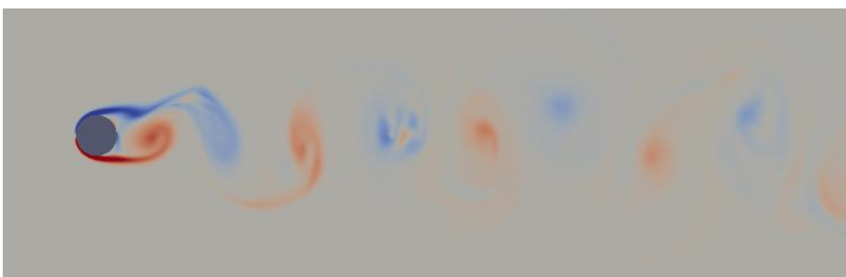
Figura 18 - Campo de vorticidade (eixo z) com V_r = 8,0 - 3d – Vista frontal
